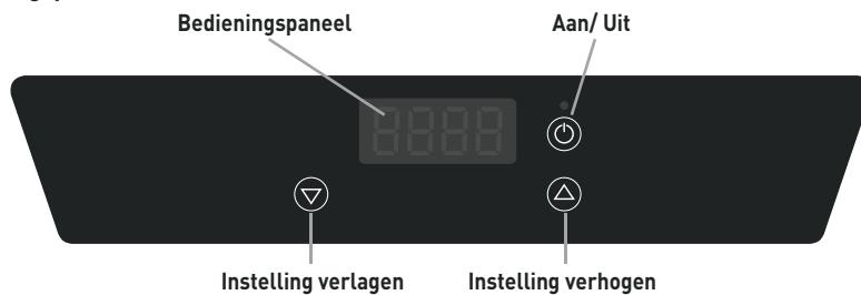
1. "ON/OFF" toets: Gebruik deze toets om het apparaat in te schakelen of om de timer te onderbreken of te resetten.
