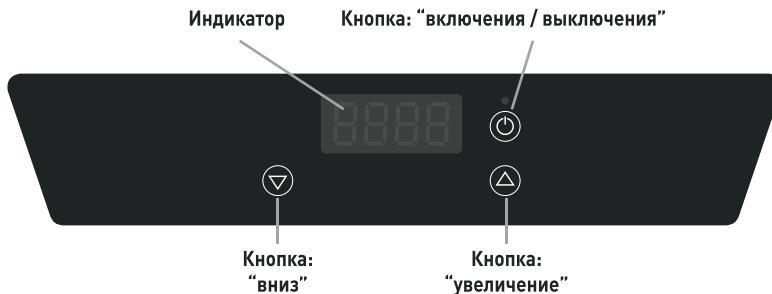
1. Кнопка „ON/OFF”: Используйте эту кнопку, чтобы включить устройство, остановить работу или сбросить таймер.
