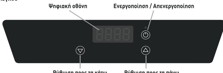
1. Πλήκτρο ON/OFF: Χρησιμοποιήστε αυτό το πλήκτρο για να ενεργοποιήσετε τη συσκευή ή για να διακόψετε ή να επαναφέρετε το χρονόμετρο
