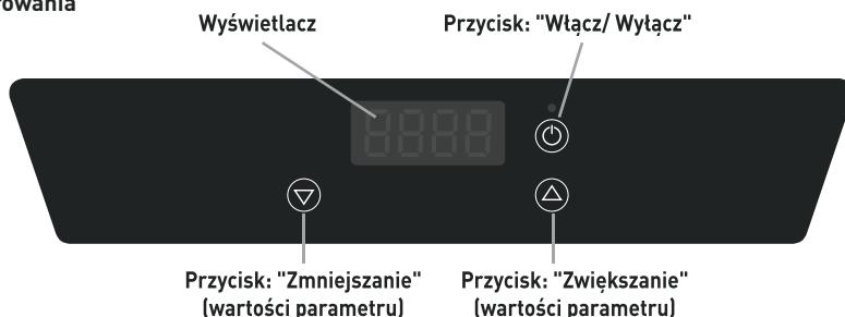
**PL** 1. Przycisk „ON/OFF”: Użyj tego przycisku, aby włączyć urządzenie lub aby przerwać lub zrejestrować ustawianie czasu.
